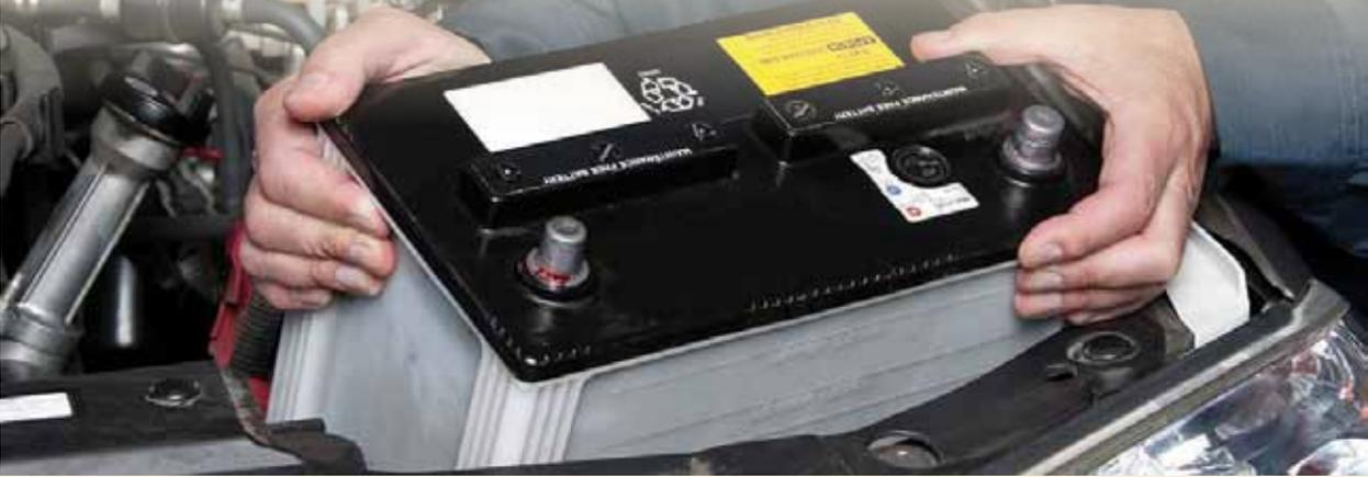
وينصح الخبراء أيضاً بضرورة تنظيف جسم البطارية وأقطابها من الأوساخ وعوامل الرطوبة بواسطة قطعة قماش مصنوعة من مواد مقاومة للشحنات الكهربائية الساكنة بالإضافة إلى حماية الأقطاب من الصدأ وتنظيفها بالنشادر أو كربونات الصوديوم، هذا بالطبع عزيزي القارئ بعد نزع كابلات الشحن (السالب أولاً).
